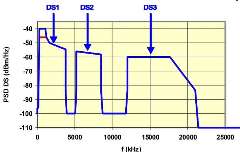
Obr. 7: Nominální charakteristika PSD DS odvozená z masky B8-12
